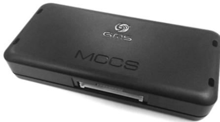
このデバイスを車両に取り付けることで、遠隔でエンジンの起動制御や位置情報のリアルタイム把握ができるようになります。
